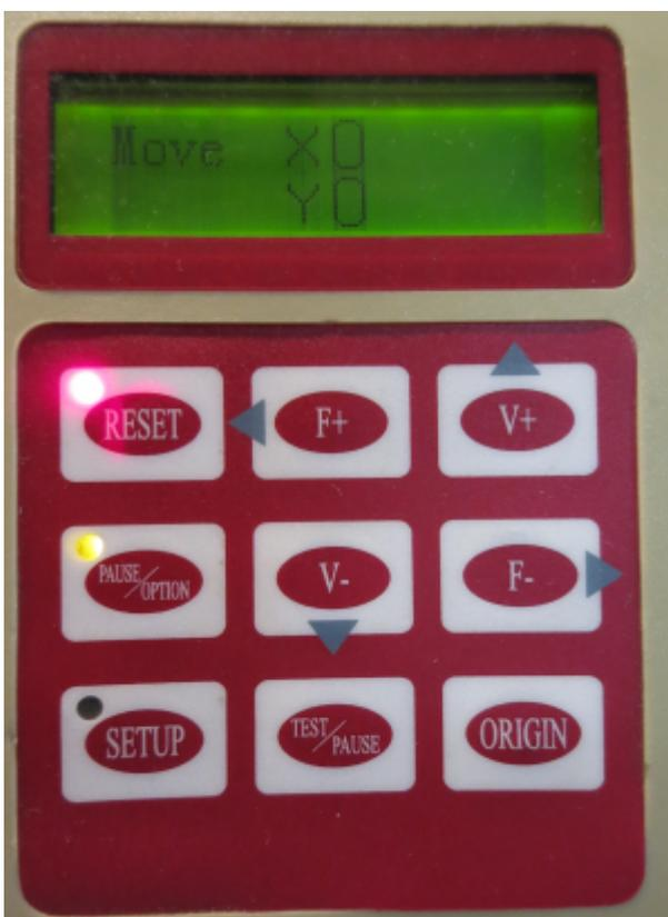
Wird danach **ORIGIN** gedrückt, wird die angefahrne Position als neuer Nullpunkt gespeichert. Wird danach wieder „**Pause/Option**“ gedrückt, so fährt das Messer bzw. die Folie zum ursprünglichen
