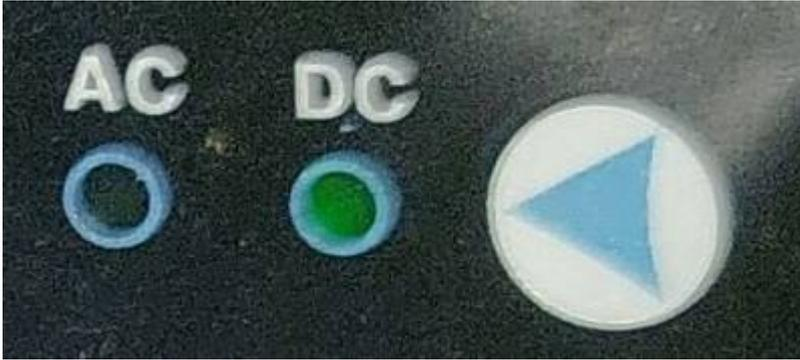
Abhängig vom Schweißverfahren und dem zu verschweißenden Bauteilen muss zwischen AC/DC gewählt werden.
