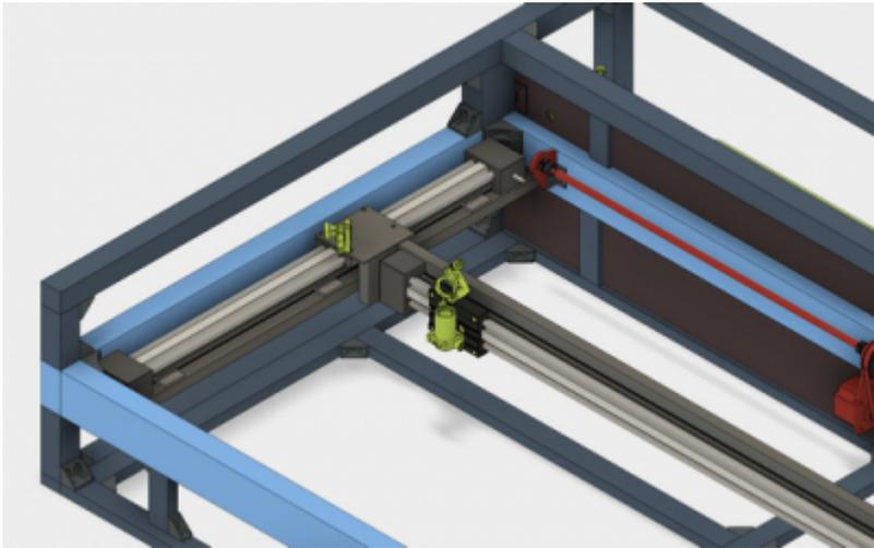
Die Mechanik des Lasersaur hat mittlerweile, nach zwei Jahren Betrieb, einige Probleme. Qualitätseinbußen bis zum Totalausfall sind absehbar. Unser aktueller Aufbau, der ein Rotieren der Y-Schienen unmöglich macht, ohne den Rahmen komplett zu zerlegen verhindert z.B. ein einfaches Drehen auslaufener Kanten.
