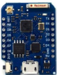
Als Controller wird ein ESP8266 in Form eines WeMos D1 mini verwendet.
