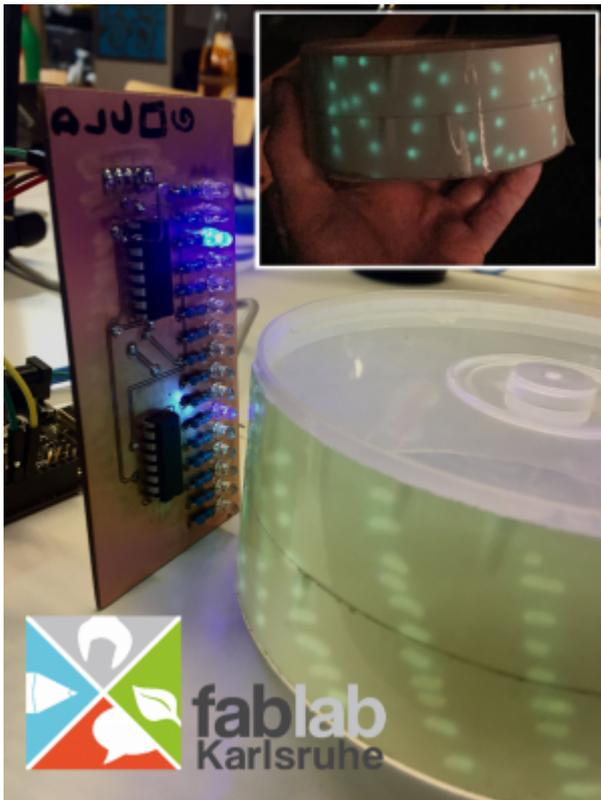
In diesem Projekt soll ein Display gebaut werden, bei dem mit UV-Leds auf phosphoreszierende Folie ein Text oder Grafiken geschrieben werden kann. Die Folie wird dafür auf eine rotierende Trommel geklebt. Der Aufbau soll aber auch zum Modden einladen, um Displays in beliebigen Formen (Scheibe, Band, ...) zu realisieren.
