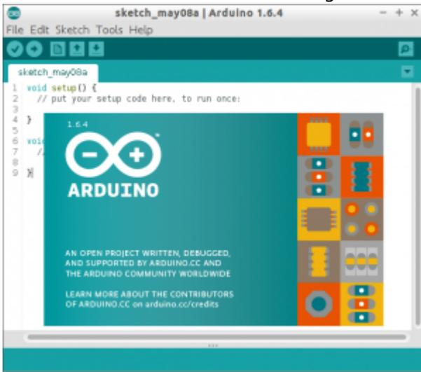
Zur Programmierung wird eine Arduino-Entwicklungsumgebung (Version 1.0, die man z.B. auf ubuntu 16.04 findet, ist allerdings zu alt) und die ESP8266-Anpassung benötigt. Eine Anleitung findet man unter [https://wiki.wemos.cc/tutorials:get\\_started:get\\_started\\_in\\_arduino](https://wiki.wemos.cc/tutorials:get_started:get_started_in_arduino)
