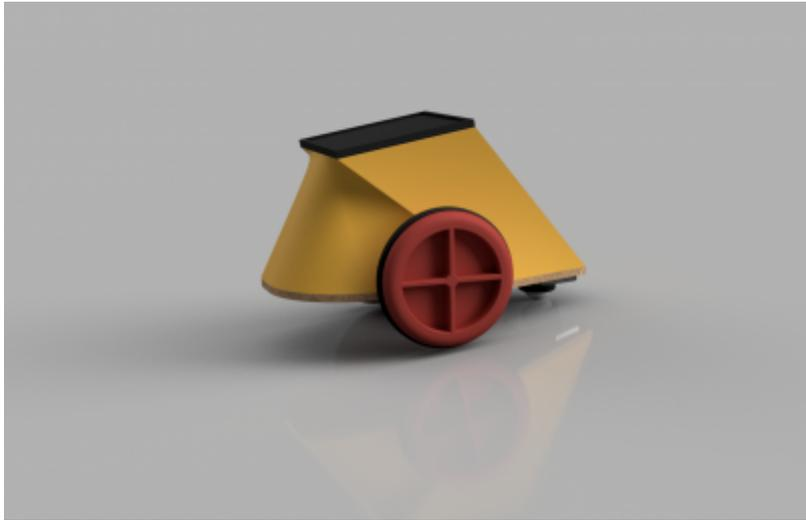
ESP8266 basierter Roboter mit 2 Rädern.
