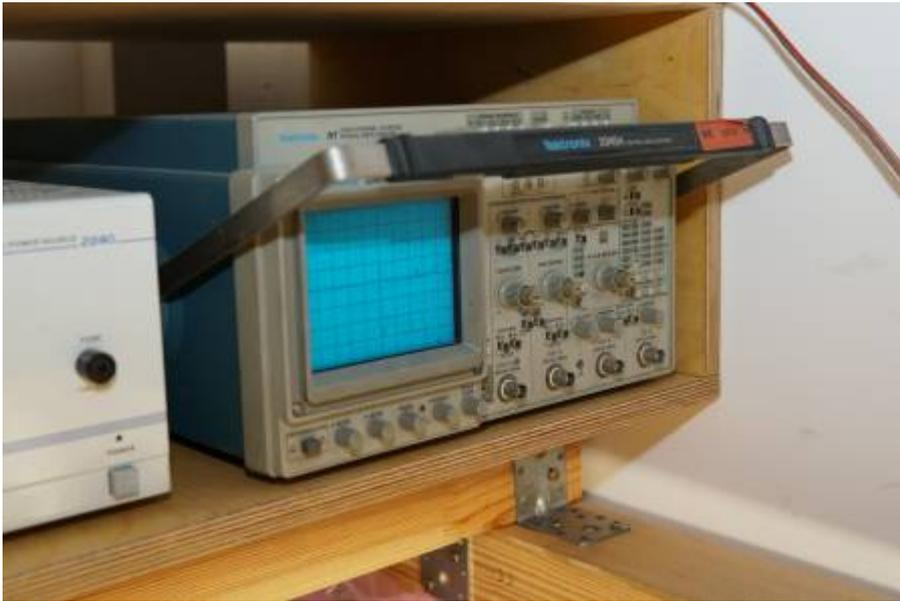
Das TekTronix 2245A ist ein analoges [Oszilloskop](#). Es ist kein Speicheroszilloskop, es können deshalb grob gesprochen nur sich gleichförmig wiederholende Signale ausgewertet werden.
