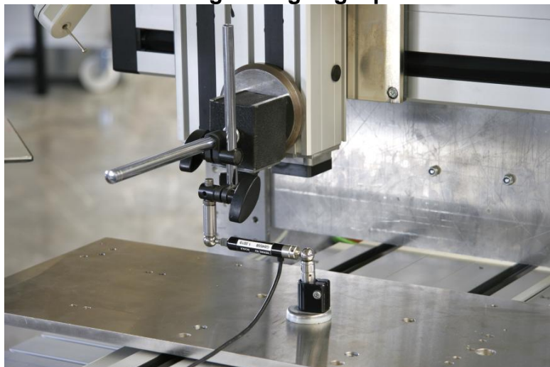
Abbildung 4: Kreisform-Vermessung mit dem Kreisformmesssystem QC10 von Renishaw
