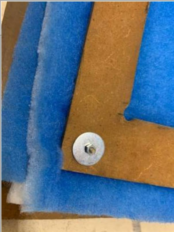
Vlies komprimiert lassen, Rahmen auflegen und mit einer Unterlegscheibe und Mutter sichern. Die Mutter nur ein par Umdrehungen aufschrauben.
