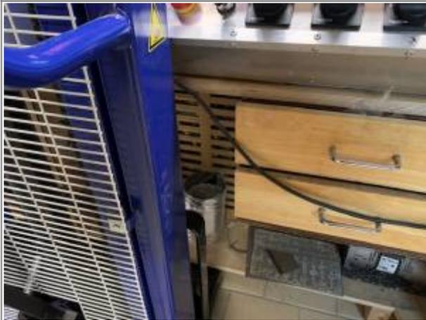
Hubwagen holen und gerade unter dem Laser platzieren. Aufpassen dass die Schubladen beim Anheben nicht eingeklemmt werden. Hubwagen so weit wie möglich unter den Laser schieben.
