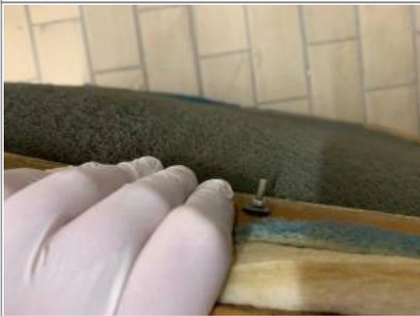
Die zwei Holzrahmen zusammendrücken, und die M3 Muttern abschrauben und Unterlegscheiben abnehmen.
