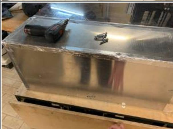
Schrauben im linken Feld hinter dem LaserSaur mit Akkuschauber und 4mm Inbus Bit abschrauben. Achtung, die Platte kippt ohne Schrauben nach hinten.
