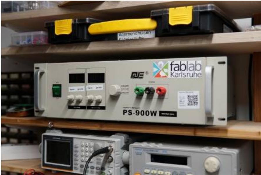
Regelbares Netzgerät, 0-15V/0-60A, 0-30V/0-30A, 0-60V/0-15A, als Schaltnetzteil, aktive Kühlung.
