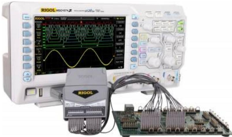
Digital Oszilloskop mit vier analogen Kanälen, 70MHz Bandbreite, Sample-Rate bis 1 GS/s, grosses Display + 16 Kanal digital Logic Analyzer.
