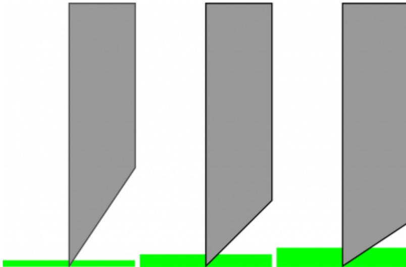
Der Nachteil des flacheren Winkels liegt jedoch darin, dass die Schneidequalität bei spitzen Winkeln und engen Kurven abnimmt. Generell sollte daher bei flacheren Winkeln auch mit geringerer Vorschubgeschwindigkeit gearbeitet werden.
