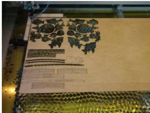
Die Teile werden jeweils doppelt (je einmal spiegelverkehrt) geschnitten und anschließend mit Ponal verklebt, so kann auf beiden Seiten eine Gravur erstellt werden.
