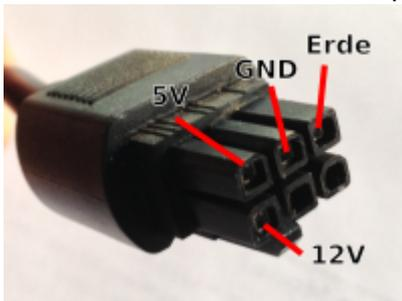
Wenn das Netzteil jetzt eingeschaltet wird, sollte das System anlaufen. Je nach Konfiguration meldet es sich sogar mit einem Piepston. Die Sieben-Segment-Anzeige (7seg abgekürzt) sollte nur kurz aufleuchten und dann einen Punkt anzeigen. Wenn sie dauerhaft etwas anzeigt, dann ins Handbuch auf Seite 80 den Fehler suchen.
