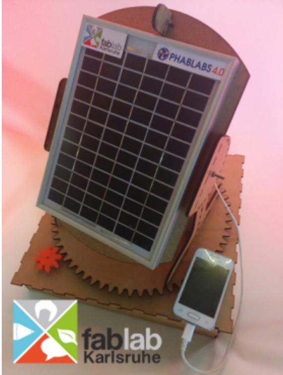
Jeder Workshopteilnehmer baut unter Anleitung eine Apparatur die automatisch eine Solarzelle optimal zur Sonne ausrichtet und nachführt (Heliostat).
