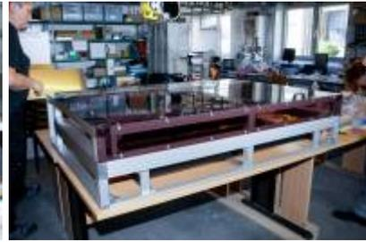
Am Sonntag wurde der Rahmen nebst X- und Y-Mechanik fertiggestellt. Bei der Befestigung der Laserröhre wichen wir wieder vom Bauplan ab, und haben stabile Lagerböcke für die Befestigungen entworfen, die mit der Röhre zusammen geliefert wurden.
