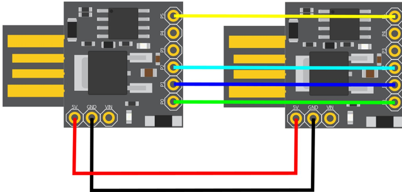
MOSI und SCKL-Leitungen im Zweifel mit Widerstand  $1k\Omega$  versehen, falls auf dem zu programmierenden Controller (Ziel) diese Pins als Output gesetzt sind!
