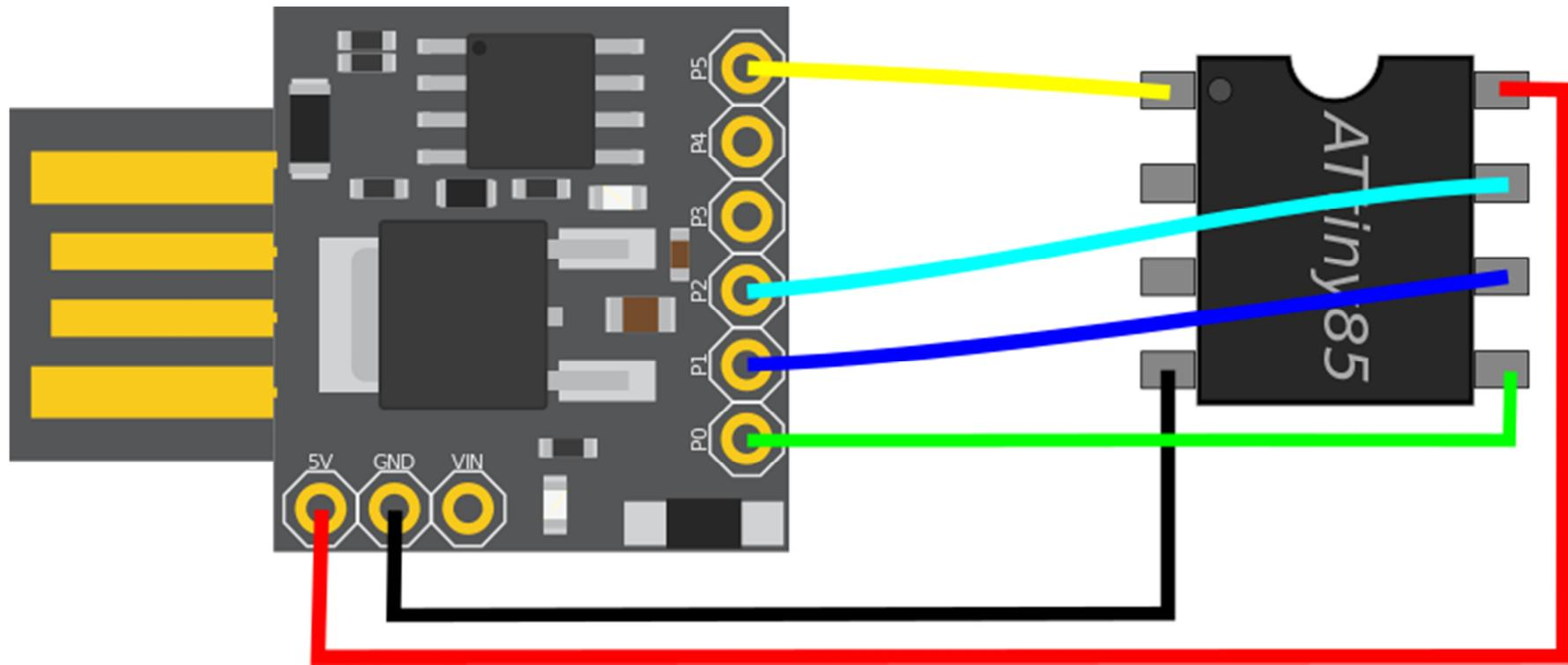
MOSI und SCKL-Leitungen im Zweifel mit Widerstand  $1k\Omega$  versehen, falls auf dem zu programmierenden Controller (Ziel) diese Pins als Output gesetzt sind!
