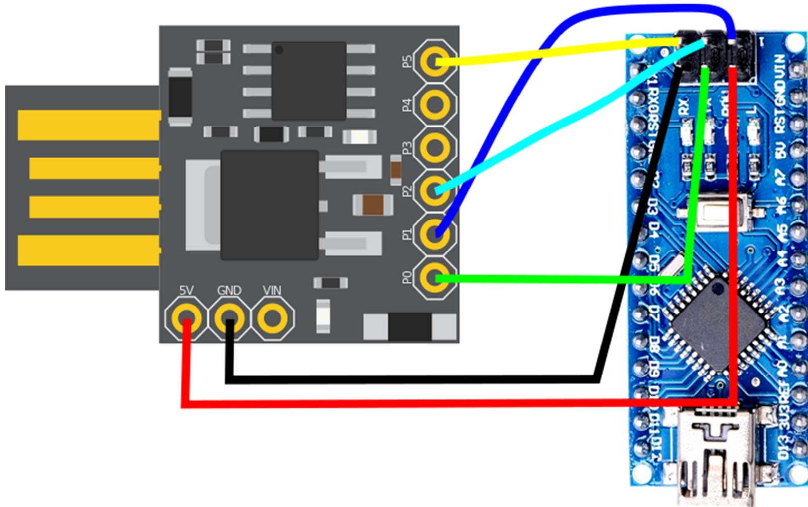
MOSI und SCKL-Leitungen im Zweifel mit Widerstand  $1k\Omega$  versehen, falls auf dem zu programmierenden Controller (Ziel) diese Pins als Output gesetzt sind!
